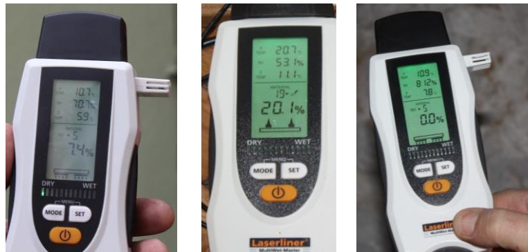
Fot. 1. Pomiary wilgotności względnej i temperatury powietrza, od lewej: pomiar na zewnątrz budynku, w sali gimnastycznej i w piwnicy
