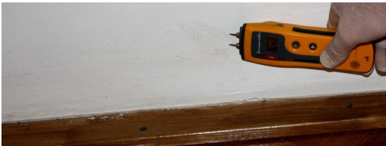
Ściana wewnętrzna Sali znajdująca się nad piwnicą - zawilgocona
